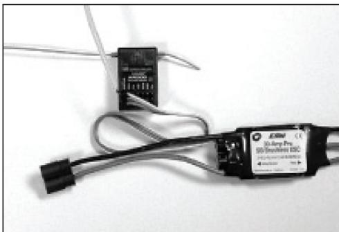
**Hinweis:** Wenn Sie den Empfänger mit einer BEC Stromversorgung mit Spannung versorgen, stecken Sie den Bindestecker in den **BATT/BIND** Port des Empfängers. Danach stecken Sie den Reglerstecker in den Gaskanal.
