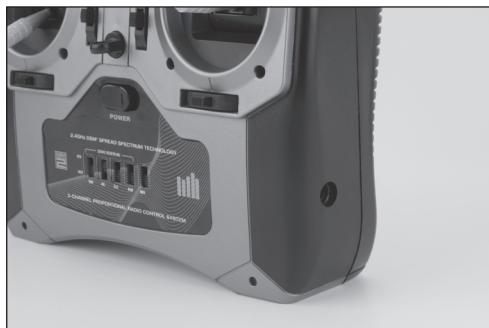
Die Ladebuchse befindet sich auf der rechten Seite des Senders. Wiederaufladbare Akkus können über diese Buchse bequem geladen werden.
