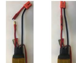
Trennen Sie die Steckverbindung vor jeder Benutzung. Wenn Sie Ihren LiPo mit dem Hauptstecker verbunden haben, müssen Sie lediglich die den offenen Draht der Sicherung berühren. Es wird kein Blitz mehr sichtbar sein.
