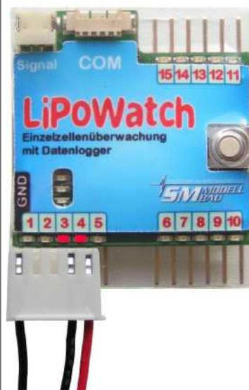
Auch ein Polyquest Stecker mit Lücken in der Belegung funktioniert problemlos. Die nicht belegten Zellenanschlüsse werden automatisch erkannt und mit 0 V gespeichert.
