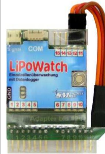
Auch für 12s an zwei 6s Steckern gibt es einen entsprechenden Adapter (Best.-Nr. 2612). Der dreipolige Stecker muss dabei wie im Bild gezeigt an den Anschlüssen 11 und 12 eingesteckt werden.
