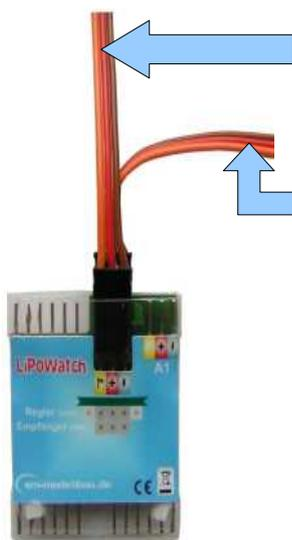
Mit dem mitgelieferten Patch Kabel (zwei mal GPN Buchse) wird die Verbindung zwischen dem **LiPoWatch** und dem Gaskanal des Empfängers hergestellt. Am **LiPoWatch** steckt das Kabel an der oberen Stiftleiste.
