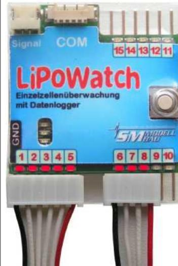
Bei z. B. 8s werden die Stecker aufgeteilt auf die zwei Blöcke. Hier sollte immer zuerst der obere und dann der untere Stecker angeschlossen werden, damit die Zellenerkennung nicht neu startet.
