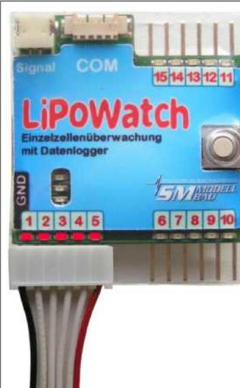
Bis zu 5s werden am ersten Pin Block angesteckt.
