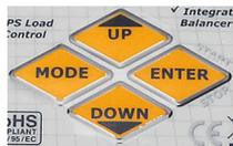
**MODE:** Vor dem Laden/Entladen:Blättern durch MENÜS für MEMORY (Charging), USER SETUP, DATA VIEW, BALANCER. MODE wählt auch den SOLO- und SYNC-Mode für mehr als 6s Akkupacks.
