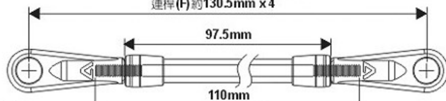
Linkage rod(F) Approx. 130.5mm x 4 連桿(F) 約130.5mm x 4
