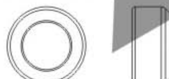
Damper rubber-black 80° 橫軸墊圈 黑色80° (φ7.9xφ13x6.5mm) x 2
