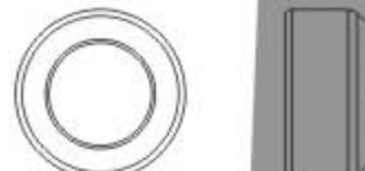
Damper rubber-red 60° 橫軸墊圈 紅色60° (φ7.9xφ13x6.5mm) x 2
