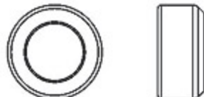
Damper rubber-red 60° 橫軸墊圈 紅60° (φ7.9xφ13x6.5mm) x 2
