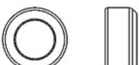
Damper rubber-black 80° 橫軸墊圈 黑色80° (φ7.9xφ13x6.5mm) x 2
