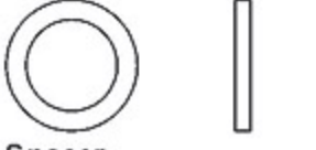
Spacer 橫軸墊圈(φ8xφ11.5x1.3mm) x 2
