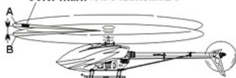
Color mark 有標示記號的主旋翼
