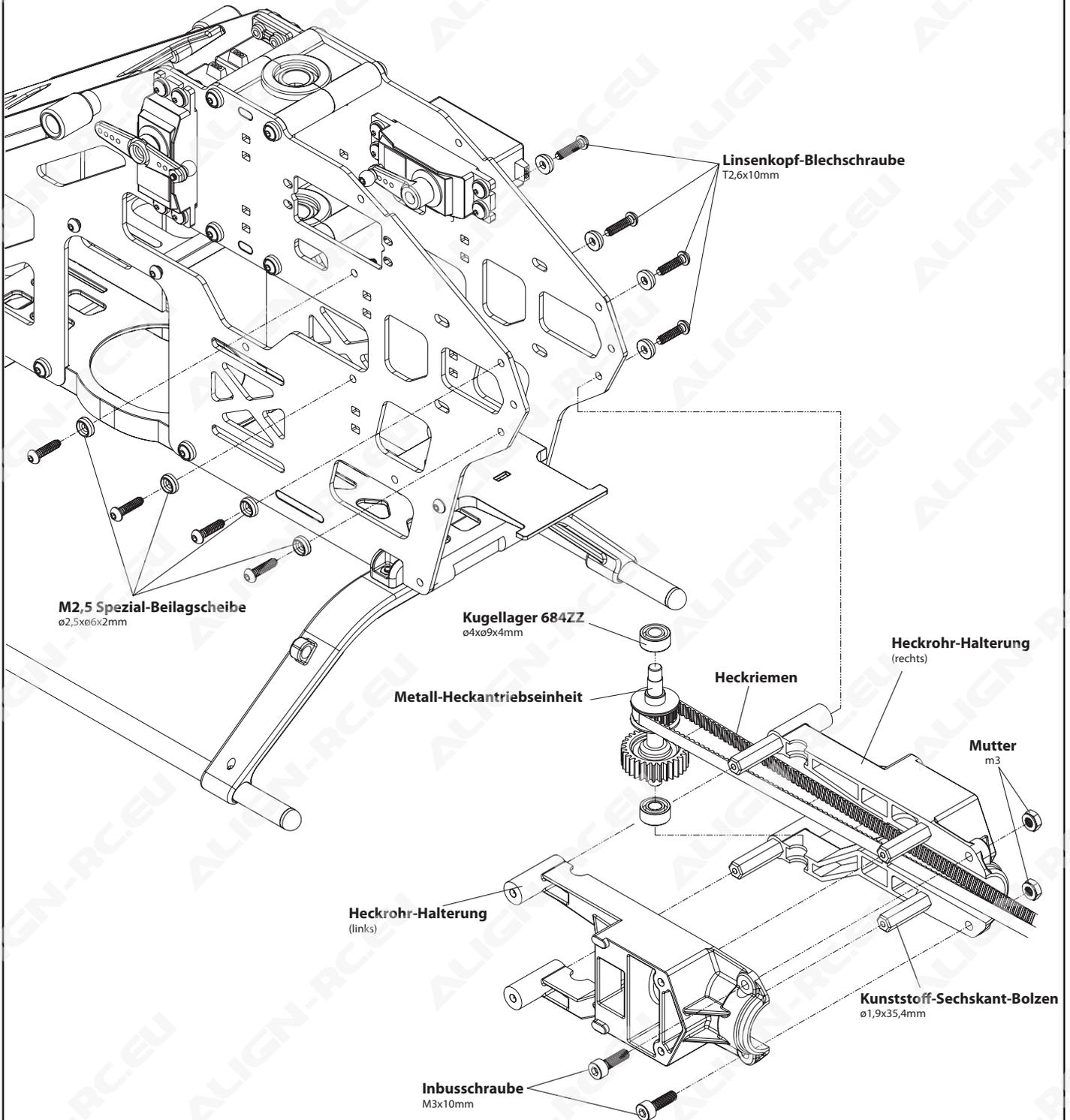
Beim Schrauben von Metallteilen immer Schraubensicherung (T43) auf die Gewinde der Schrauben auftragen!
