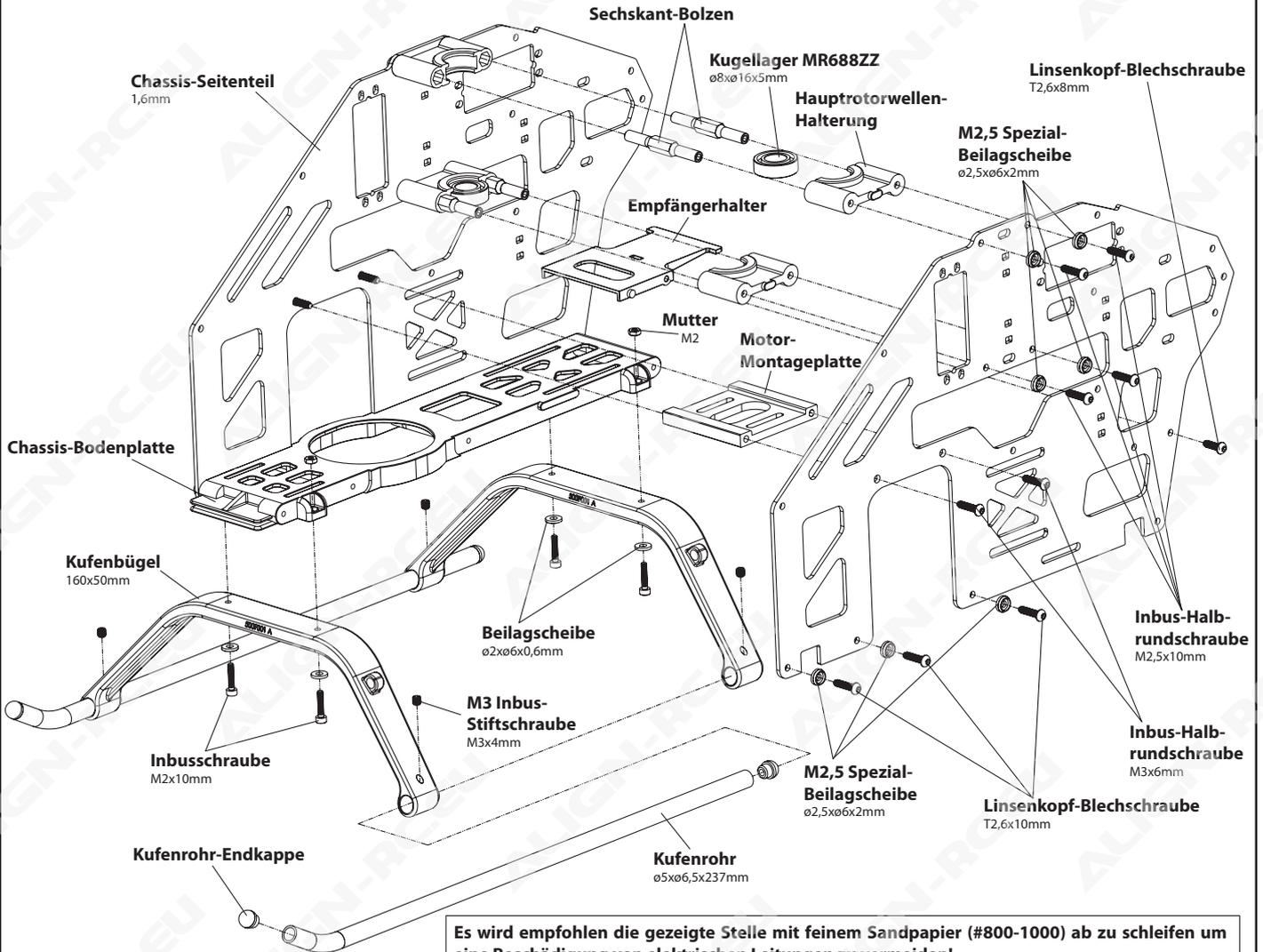
Es wird empfohlen die gezeigte Stelle mit feinem Sandpapier (#800-1000) ab zu schleifen um eine Beschädigung von elektrischen Leitungen zu vermeiden!
