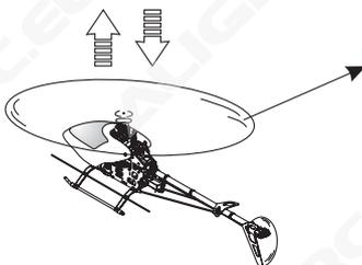
Sobald der Hubschrauber anfängt leicht zu werden und vom Boden abheben will reduzieren Sie das Gas und bringen Sie ihn wieder sicher zu Boden zurück. Übern Sie dies solange bis dies in einer harmonischen Bewegung gelingt.
