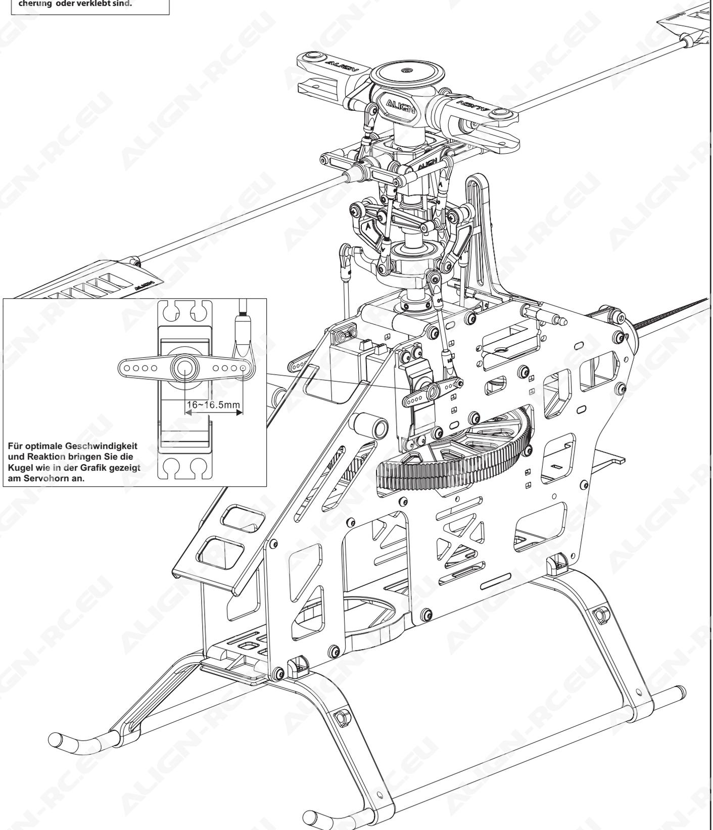
Für optimale Geschwindigkeit und Reaktion bringen Sie die Kugel wie in der Grafik gezeigt am Servohorn an.
