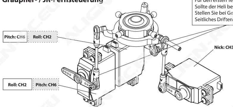
Für den ersten Testflug sollten Sie die Trimmung an der Fernsteuerung neutral einstellen. Sollte der Heli beim Testflug driften können Sie dies mit Gestänge C korrigieren. Stellen Sie bei Gestänge C gleichförmig ein um ein Driften nach Vorne/Hinten zu korrigieren. Seitliches Driften korrigieren Sie indem Sie die beiden Gestänge gegenläufig verstellen.
