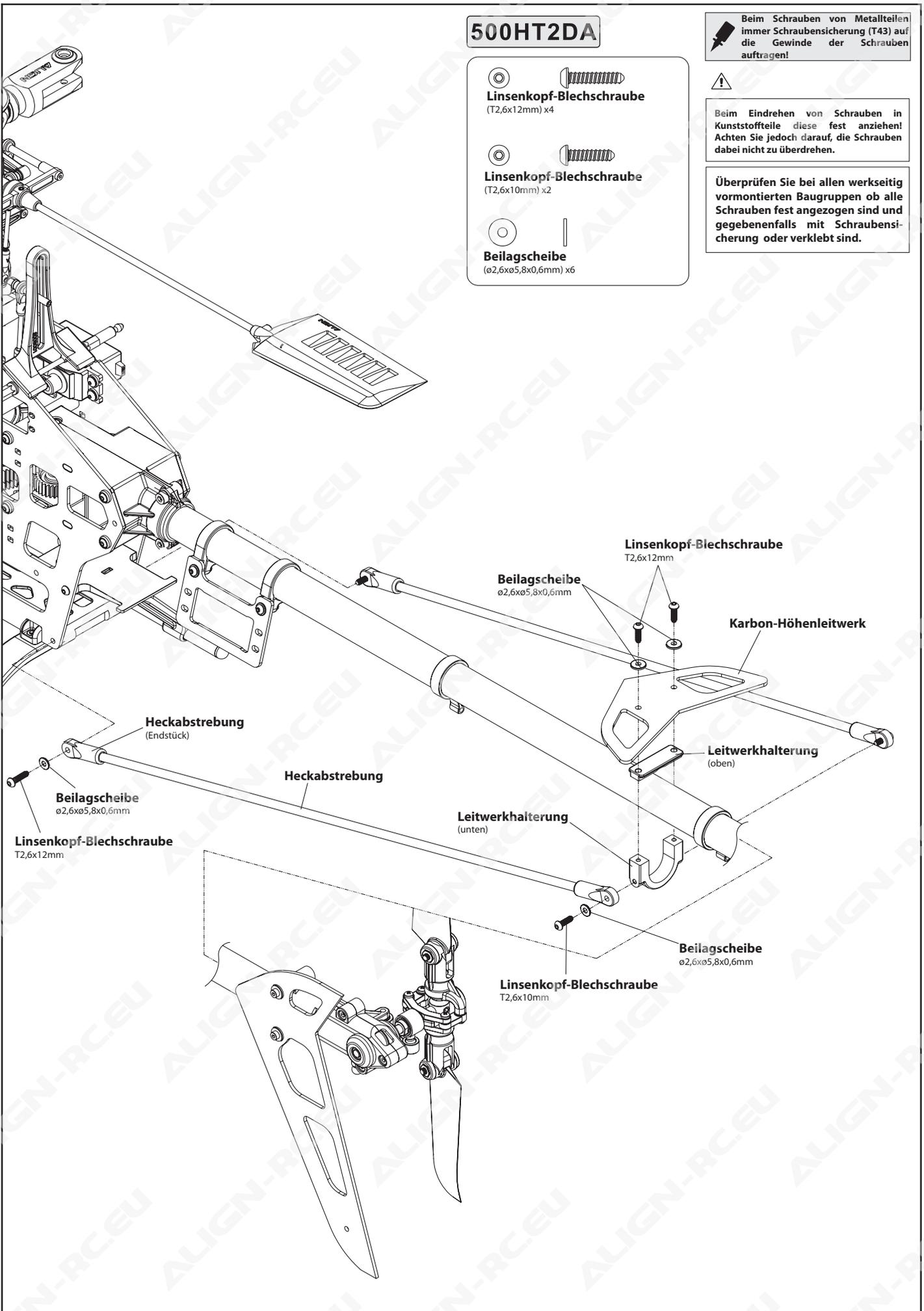
Beim Schrauben von Metallteilen immer Schraubensicherung (T43) auf die Gewinde der Schrauben auftragen!
