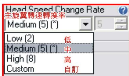
此設置為控制主旋翼轉速切換到更高的轉速時的變化率，也就是油門的反應速度。此設置只在你選擇直昇機或控制線的模式下才能使用。數值越高，當油門變換時主旋轉速的反應速度越快。
