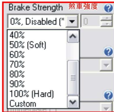
此選項可以調整煞車來達到特定的運用。煞車有兩個主要用途；停止飛機的折疊螺旋槳來做摺疊的動作和控制3D 和特技飛行的downlines動作。飛手們應該嘗試找到最適合自己的煞車及其應用。煞車制動強度變化從軟煞車到急煞車。
