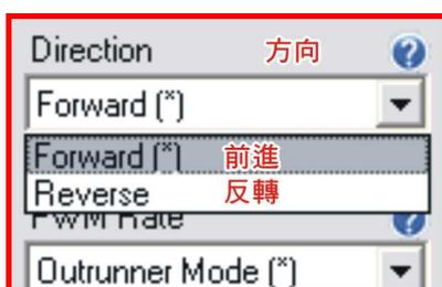
當你第一次轉動馬達，如果他是以錯誤的方向旋轉，你可以在這裡改變它的方向，而不需要對換兩條馬達線。這也幫助你已經焊接調速器到馬達上時不用擔心重焊的問題。（此設置是可以讓調速器或馬達在沒有任何風險的狀況下作修改。進角也會依改變方向自動被修正）。
