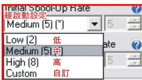
此設置控制電源如何快速大幅度從零提高到你的馬達到達指定的主旋翼轉速。此設置將只有在你選擇直昇機或 **control line** 油門模式才能使用。越快的緩啓動速度，旋翼頭的啓動運轉的速度也越快。一旦主旋翼轉速接近目標，緩啓動功能會停止。你可以經過測試來找出哪種啓動速度對你來說是最好的。有些飛手喜歡緩慢的緩啓動，有些喜歡快的。
