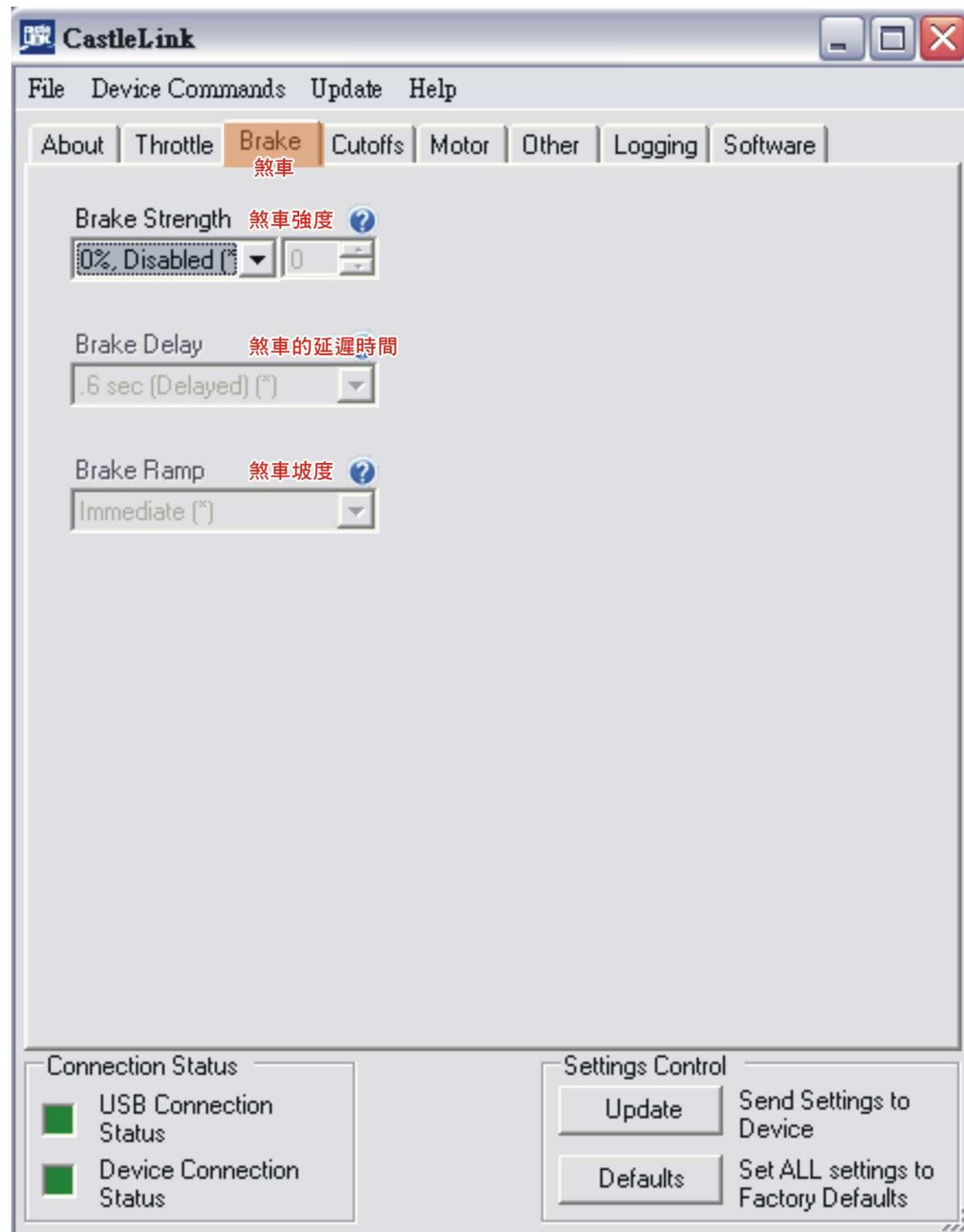
附註：選擇直昇機模式時將自動關閉煞車頁面的設定選項。
