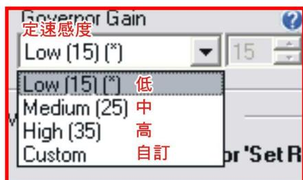
此設置運作方式就如你的陀螺儀感度。太低的話，定轉速的反應會變模糊而且轉速落差明顯。太高的話馬達轉速也會有類似追蹤的情形，可聽到馬達抖動的聲音。一般來說，較大的直昇機需要較高的感度來達到修正轉速。
