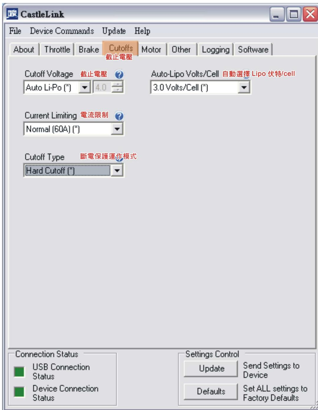
在截止電壓是設定為保護避免鋰電池過度放電（每個 cell 電壓低於 3V 時）。如果您使用的是鎳氫或鎳鎘電池，你不會需要使用截止電壓設置來保護電池，因為這些類型的電池可以讓你長時間飛行至完全放電。如果您使用的是大於 6NiXx 電池，設置您的 cut 至 5 伏特的電壓。如果您使用的是 6 或更少的 NiXx 電池設置你的 cut 到 4 伏特的電壓。
