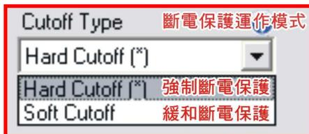
設定當 ESC 到達截止電壓時，啓動截止電壓保護的方式。
