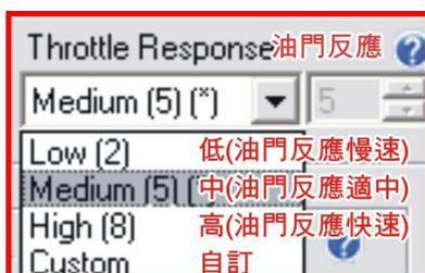
此設定為從某一油門數值切換到另一油門數值提供一個變化率。較高的油門反應設定會使得變換油門數值時產生較少的抑制。較低的油門反應設定會使得變換油門數值時明顯感覺反應變的”模糊”或是遲緩。較高的反應等級會使油門變化時油門反應更加迅速。在固定行程模式下,這個設定對於”fine tuning”的油門反應時間甚是重要,以保持 pitch 變化時的轉速。
