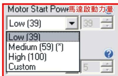
這個設定是控制馬達在啟動運轉時需要輸出多少的力量，不同的動力系統與飛機、直昇機，設定也不同。最好的設定方式是一開始先設定較低的設置，接著再嘗試找
