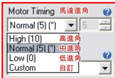
馬達進角設定能改變範圍內推動馬達的時間。一般而言，低進角設定能提升效率同時也會減少動力，高進角設定能提高動力也會使馬達容易過熱。每個馬達將對應不同的進角設定。當任何馬達接上時，卡斯特調速器會自動的找出正確且最佳的進角設定。你也可以透過這項設置功能，做向上或向下調整。
