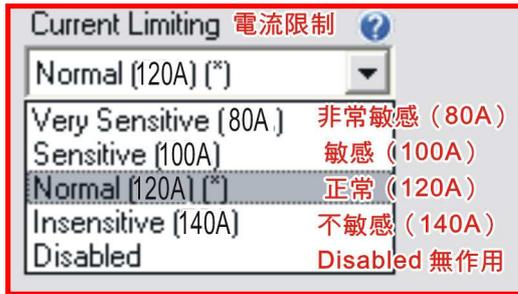
卡斯特調速器內置有幾種形式的內建保護，其中之一是'電流'。此設定可以讓調速器自我保護，避免電流過大或不適當的電池。一般而言，飛機的使用是不需要改變此設置的除非你是要做測試用。如使用直昇機模式可以將數值放大，並且將減少了調速器的關閉馬達的機會。但是這會增加調速器電流過大的風險。使用電池的放電容量太低有時可以因為不平穩的電流而開啓這種保護功能。如果你遇到過早的切斷，改變此設置來符合所需的功能。確認你的電池組和連接器，以確保它們有足夠的耐電流。
