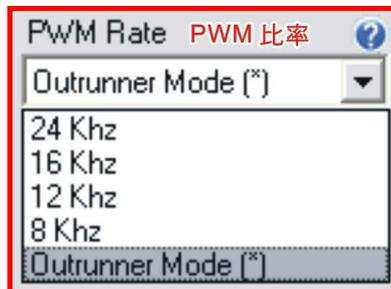
此設置更改調速器傳送 **power pulses** 的頻率。某些馬達種類，使用較高的頻率能使馬達效率更好，但是通常都會使調速器溫度升高。如果您決定嘗試修改 **pwm**，請使用瓦特計，轉速計和溫度槍來找出此變化如何影響您的電力系統。**PWM** 頻率的增加，通常會增加調速器的溫度。它也有可能或可能不會降低馬達的溫度。
