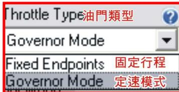
使用此下拉框來選擇你想使用的油門控制方式。不同的種類會開啓不同的選擇，例如：直昇機裡並沒有自動校準模式。自動校準行程和固定行程模式下，油門信號越來越高，馬達的轉速也會增加。定速模式則以油門信號的範圍來界定馬達旋轉的速度。ESC 會在此速度上試著保持或定速。
