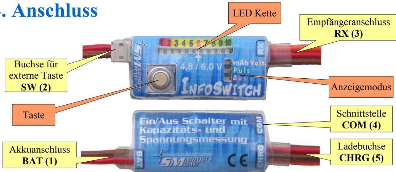
Der **INFOSWITCH** besitzt die selben drei Anschlusskabel wie jedes normale Schalterkabel plus einen Anschluss für die Schnittstelle und einen externen Taster:
