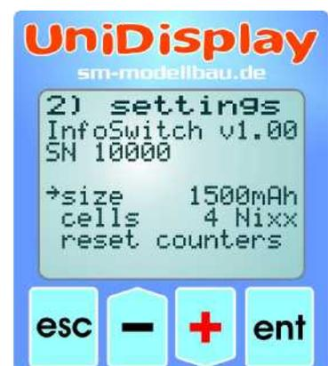
Mit „size“ kann die Sollkapazität vorgegeben werden. Dabei wird auch automatisch die Zellenzahl aus der Akkuspannung neu bestimmt. Sollte die automatische Zellenzahlerkennung einmal nicht stimmen, kann unter „cells“ manuell ein Wert eingegeben werden. Ebenso kann hier ab Firmware v1.08 auf Eneloop Zellen umgestellt werden.
