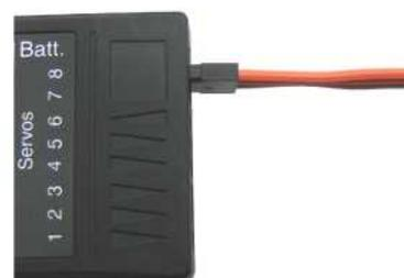
Anschluss an einer Servobuchse **mit** Impulskabel
