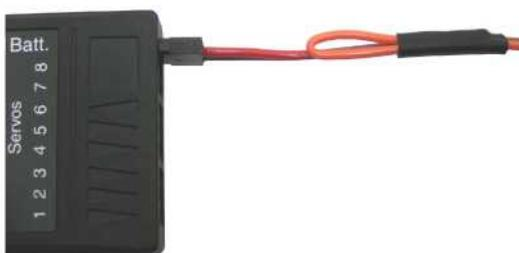
Anschluss an der "Batt." Buchse **ohne** Impulskabel
