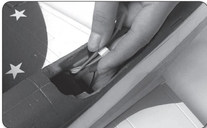
Setzen Sie nun den Antriebsakkku (2s LiPo 7,4V / 450mAh) in den vorderen Teil des Rumpfes ein. Akku jetzt noch nicht am Regler anschließen! / Install the battery (2s LiPo 7,4V / 450mAh) in the front area of the fuselage. Do not connect the battery with the speed controller now! / Ora inserire la batteria (2s LiPo 7,4V / 450mAh) nella parte anteriore della fusoliera, ma non collegarla ancora con il regolatore!
