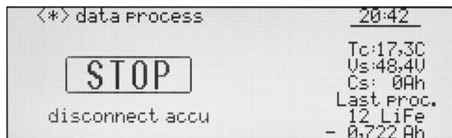
Beendigung des Prozesses ist auf der linken Seite dargestellten Display angezeigt, eine entsprechende Meldung (hier „STOP“ und das Blinken der Displaybeleuchtung) wird ausgegeben. Wenn im Setup der Beeper (akustisches Signal) aktiviert ist, wird auch akustisch signalisiert. Die akustische Signalisierung schaltet nach ca. 30 Sekunden auf ein leises Klacken um,
