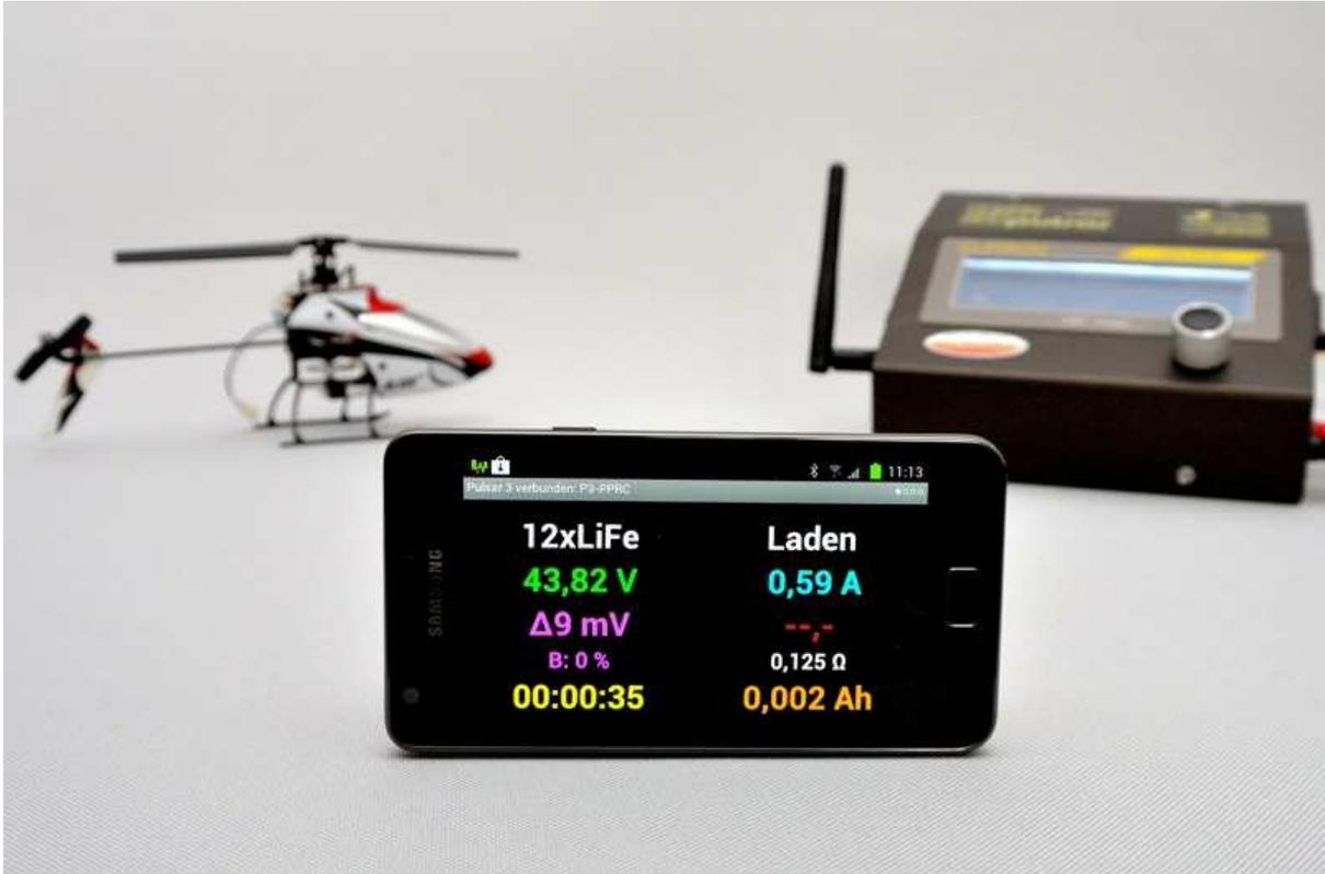
Die Android-App ist sowohl für Smartphones als auch für Tablett-Computer geeignet. Über schnurlose BT-Kommunikation können die am Pulsar 3 ausgeführten Prozesse überwacht und kontrolliert werden.
