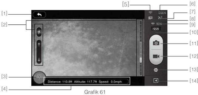
[1] Zurück [2] vertikale Kameraneigung [3] Radarfunktion [4] Flugdaten [5] W-Lan Signalstärke [6] Ladestand Flugbatterie [7] gefundene GPS Satelliten [8] Micro-SD Karten Status [9] Ladestand W-Lan Verstärker [10] verbleibende Aufnahmen [11] Auslöseknopf [12] Videoaufnahme starten/beenden [13] Kameraeinstellungen [14] Flugdaten verdecken/sichtbar machen
