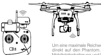
Um eine maximale Reichweite zu gewährleisten, richten Sie die Antenne der Fernsteuerung direkt auf den Phantom. Gegenstände dazwischen könnten den FailSafe einleiten. Mobiltelefonhalterung und W-Lan Verstärker sollten die Antenne nicht beeinflussen.
