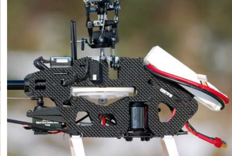
Markant sind der vorne angeordnete Motor, das einstufige Getriebe und der Heckrotor-Kegeltrieb. Der Heckrotorantrieb erfolgt über Starrwelle. Der LiPo-Akku sitzt ganz vorn auf einer Platte, darunter „unsichtbar“ versteckt der Controller. Das Heckservo ist elegant unter der Heckrohr-Befestigung untergebracht. Alle Kabel sind perfekt verlegt
