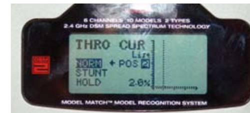
Ein Blick ins Menü zeigt, dass bei F-Model-Schalter in Stellung „0“ kein Gaswert anliegt ...
