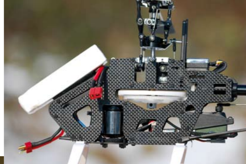
Markant sind der vorne angeordnete Motor, das einstufige Getriebe und der Heckrotor-Kegeltrieb. Der Heckrotorantrieb erfolgt über Starrwelle. Der LiPo-Akku sitzt ganz vorn auf einer Platte, darunter „unsichtbar“ versteckt der Controller. Das Heckservo ist elegant unter der Heckrohr-Befestigung untergebracht. Alle Kabel sind perfekt verlegt
