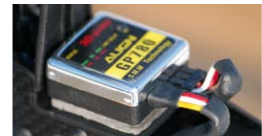
Nichts wird dem Zufall überlassen, deswegen schützt man seitens freakware alle Kabel zusätzlich vor Durchscheuern. Hier das Gyro-System GP780, das für Top-Heck-Performance sorgt
