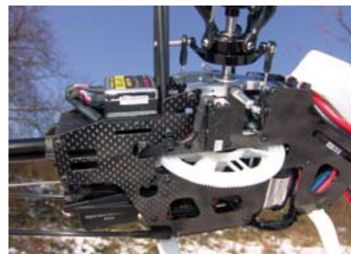
Auch am Nickservo – äußerst sorgfältige Kabelverlegung
