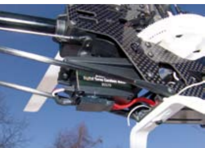
Da hat einer bei der Vormontage mitgedacht: Um ein lästiges Herausfummeln des sauber verstaubten Spektrum-Empfängers zu ersparen, wurde für ein eventuelles Binden mit einem anderen Sender die entsprechende Buchse unter dem Heckservo festgeklebt
