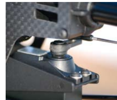
Blick auf das Heckservo. Man beachte den sauber abgeschliffenen Servohebel
