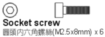
Socket screw 圓頭內六角螺絲(M2.5x8mm) x 6
