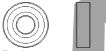
Bearing 軸承(φ5xφ13x4mm) x 2
