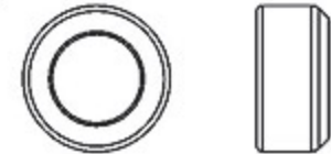
Damper rubber-black 80° 橫軸墊圈 黑色80° (φ7.9xφ13x6.5mm) x 2
