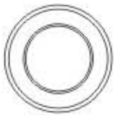
Damper rubber-black 80° 橫軸墊圈 黑色80° (φ7.9xφ13x6.5mm) x 2
