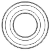
Bearing 軸承(φ10xφ19x5mm) x 2
