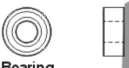
Bearing 軸承(φ3xφ7x3mm) x 4
