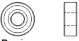
Bearing 軸承(φ3xφ8x3mm) x 2
