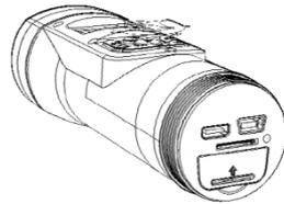
Entfernen Sie die Schraubverbindung (Port-Abdeckung), die den Kommunikationsport und den Kartenslot schützt. Schieben Sie die Karte folgendermaßen ein: Kontakte der Karte liegen oben und zeigen Richtung Display (Bedruckte Seite der Karte zeigt nach unten). Die Karte rastet hörbar ein.
